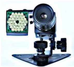
Smart-Eye-Pro-System zur Erfassung von Blickbewegungen (Bildquelle: Produktkatalog Smart Eye Pro 5.7)
